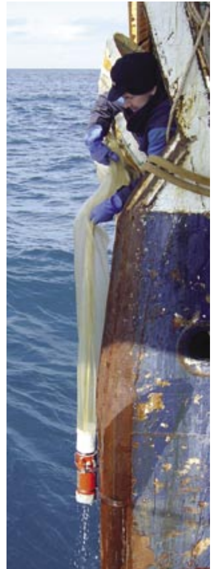
Royndirnar av makreleggum vórðu tiknar við glúpi, einum sokallaðum „Bongo-neti“. Hetta er ein ramma við tveimum glúpum, sum verður tóvað frá vatnskrupuni niður á 200 m dýpi og upp aftur. Meskaviddin er 0,280 mm.
