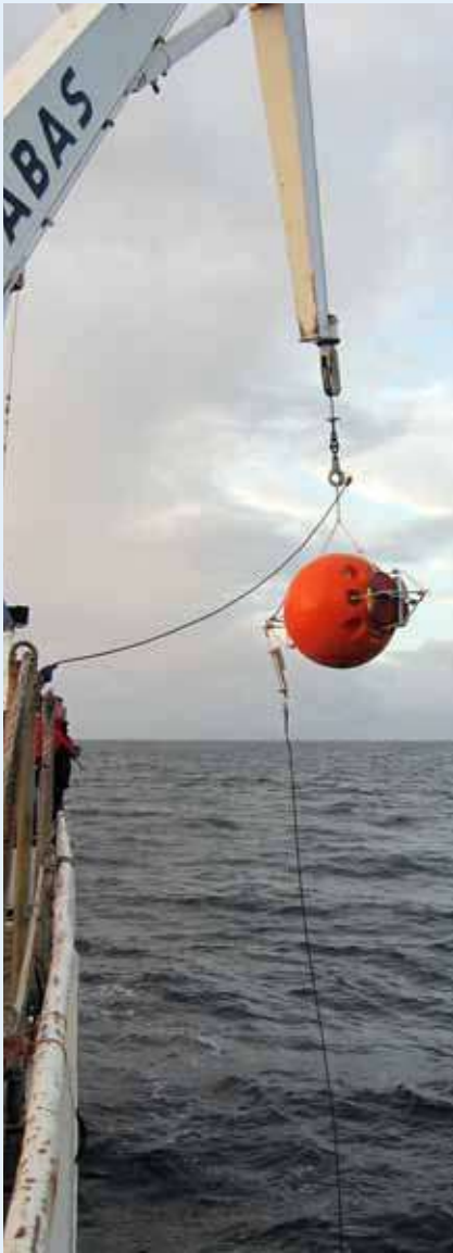
Mynd 2. Ein streymmátari verður lagdur út frá Magnusi Heinasyni. Hann skal liggja úti í eitt ár, har hann trýggjar ferðir um tíman matar streym á ymsum dýpum.
